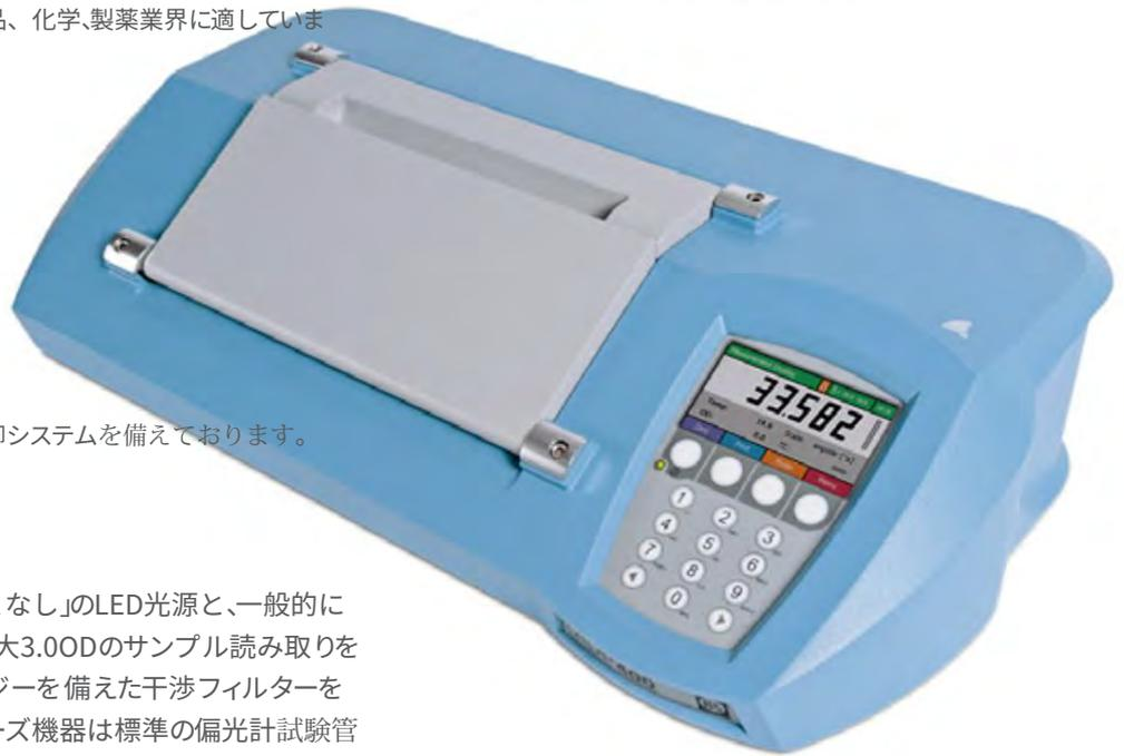
ADP400シリーズ偏光計は、「メンテナンスなし」のLED光源と、一般的に使用されるナトリウム（589nm）波長で最大3.0ODのサンプル読み取りを提供するフォトダイオード検出器テクノロジーを備えた干渉フィルターを備えています。便利なことに、ADP400シリーズ機器は標準の偏光計試験管を使用するか、サンプルが少ない場合は少量のルーアーテーパー試験管を使用します。
