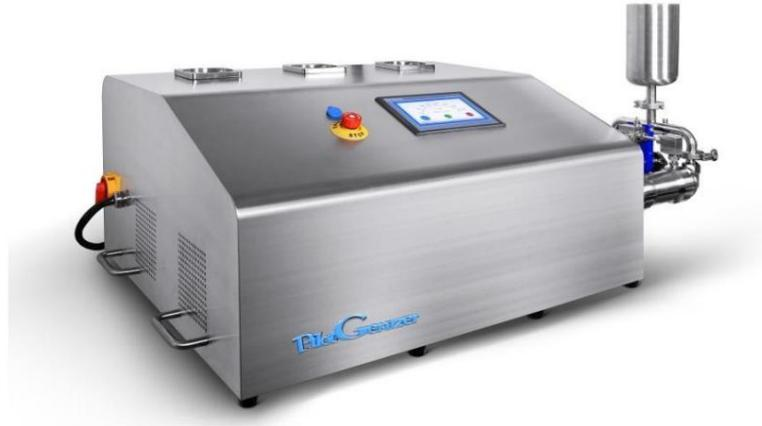
PilotGenizer デュアル ポンプ システムはデジタル制御設計に基づいており、サンプルの事前混合を助け、ナノサイジング手順を支援する補助ダイヤモンド チャンバーと、細胞を破壊する一次ダイヤモンド相互作用チャンバーを備えた使いやすい設計です。そして粒子サイズを小さくします。
