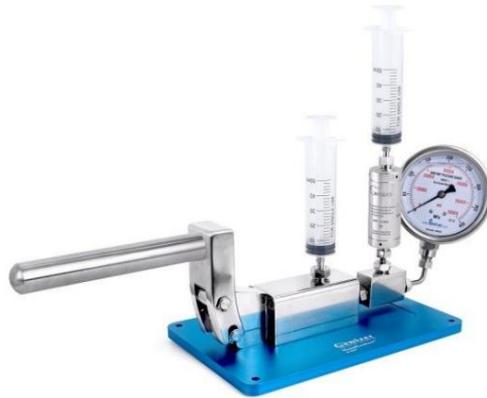
HandGenizer のミニポンプは、製品の流れに適切な圧力を提供するように特別に設計されています。ポンプハンドルを持ち上げると、少量のサンプルがミニポンプ本体に引き込まれます。ポンプハンドルを完全に下に移動してサンプル ストリームに高圧プロファイル (最大 30,000 psi) を加えると、サンプルのこの部分が逆止弁と Genizer Y タイプ ダイヤモンド インタラクション チャンバーに入ります。最後に、排出口から出て回収されます。また、Genizer オンライン リポソーム 押出機と組み合わせて、リポソームのダウンサイジングを実現することもできます。
