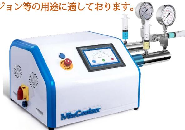
UltraGenizerより大きな流量に適した超高圧ホモジナイザー及び細胞破碎装置です。この装置の最大圧力は60,000psiです。ポンプシステムは操作が簡単でダイヤモンド相互作用チャンバーを備えているため細胞を除去し、粒子サイズを小さくします。サンプル冷却ユニットは316Lステンレス製熱交換器により、リアルタイム冷却を可能にしました。さらにタッチスクリーンは、時間、サイクル数、圧力の設定へのシンプルなアクセスを可能にしました。サンプルと接触する全ての部品は316Lステンレスです。
