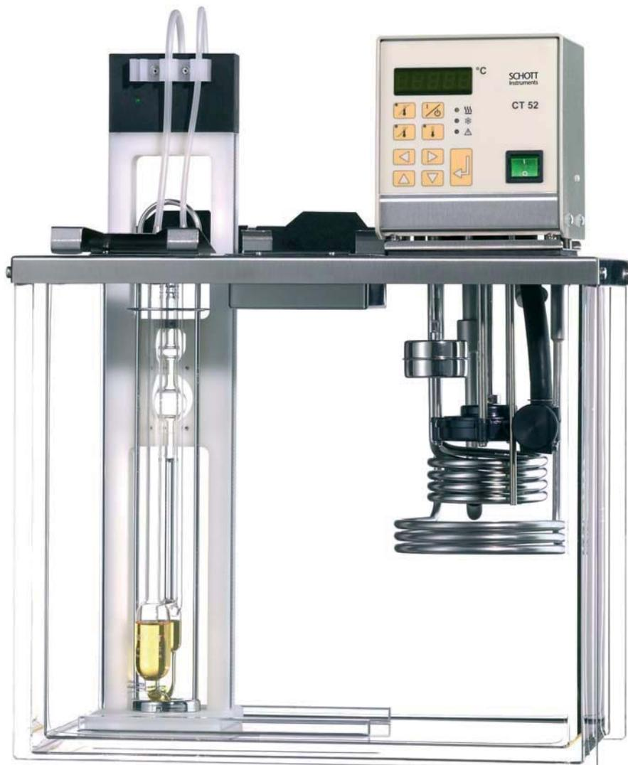
ニュートン力学に基づく液体の粘度測定は温度に極めて大きな影響を受けます。測定物質によっては温度偏差0.1Kに対して偏差0.5 から 2% になります。
