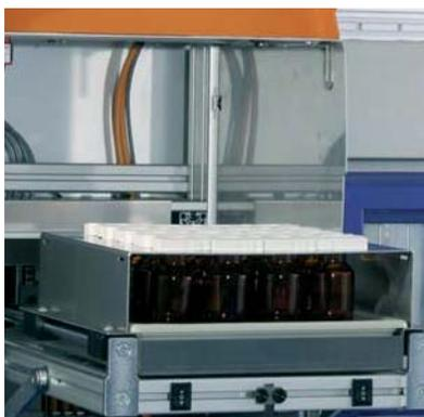
電動サンプル押し上げ機構によりラック中のサンプルの
