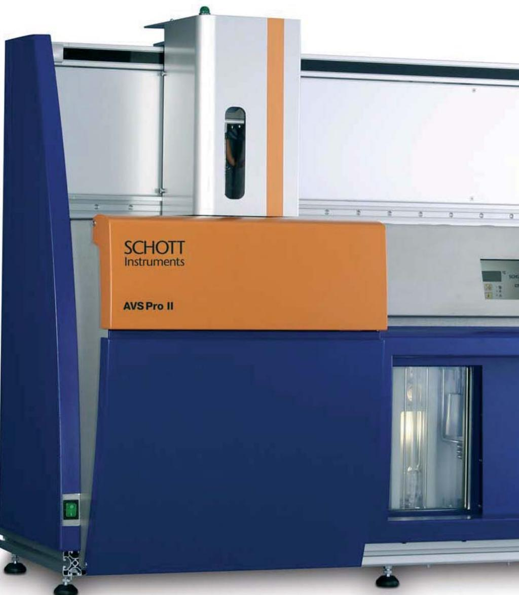
AVSPro II 自動サンプリング自動粘度測定装置はキャピラリー方式です。この方式は物理化学の分野におけるニュートンネアー液体の粘度を最も精密に測定する方法です。この方法を用いることにより、精度0.1%以上の測定が可能です。光学センサー並びにTCセンサーによる粘度測定の非常に広い応用がその大きな用途です。その中には不透明(TCセンサー)な石油製品と透明な(光学センサー)液体の測定も含まれます。
