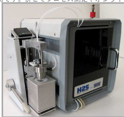
Fig. 8: ヘッドスペースモジュールの立方体H 2 S-測定器 – 小型モデル
